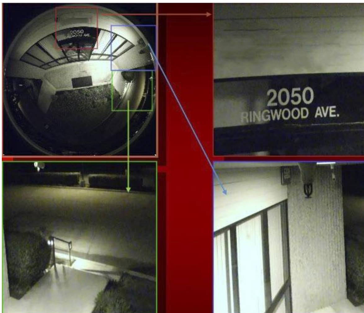
上図の全てのズームウィンドウは自動的に歪み補正が行われます。ズームウィンドウを設定して[レイアウトを保存](#)します。
