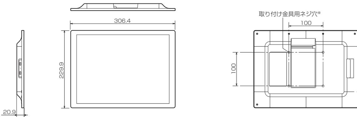
※ VESA 規格の金具の取り付けには、M4 ネジで、長さが取り付け金具の厚さ +8 ~ 10mm のものを使用してください。
