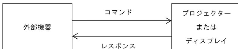
コマンドの最後には改行コードを付加してください。改行コードは ASCII コード 0Ah(LF)あるいは 0Dh(CR)です。以降<CRLF>と記載します。レスポンスの最後にもコマンドと同じ改行コードが付加されます。
