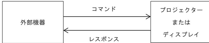
コマンドの最後には改行コードを付加してください。改行コードは ASCII コード 0Ah(LF)あるいは 0Dh(CR)です。以降<CRLF>と記載します。レスポンスの最後にもコマンドと同じ改行コードが付加されます。
